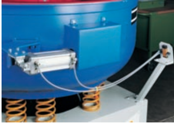
Dispositif de commande pneumatique du volet de séparation
