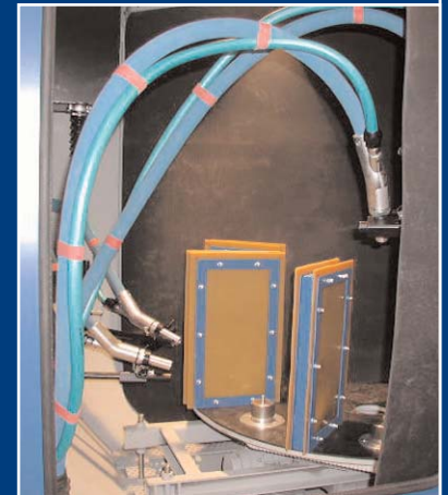
Stations de sablage
